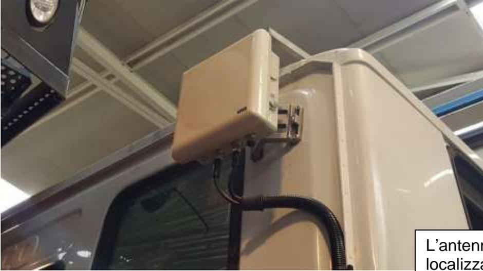
L'antenna RFID UHF collegata al localizzatore legge il TAG applicato al cassone scarrabile ogni volta che viene caricato e scaricato dal mezzo
